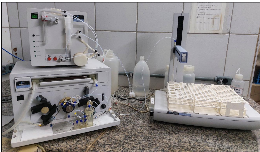
Figura 3. Espectrofotometria de absorção atômica por geração de vapor frio (FIMS-400 Perkin Elmer®) equipado com um sistema de injeção de fluxo (FIAS) com amostrador automático (S10).
