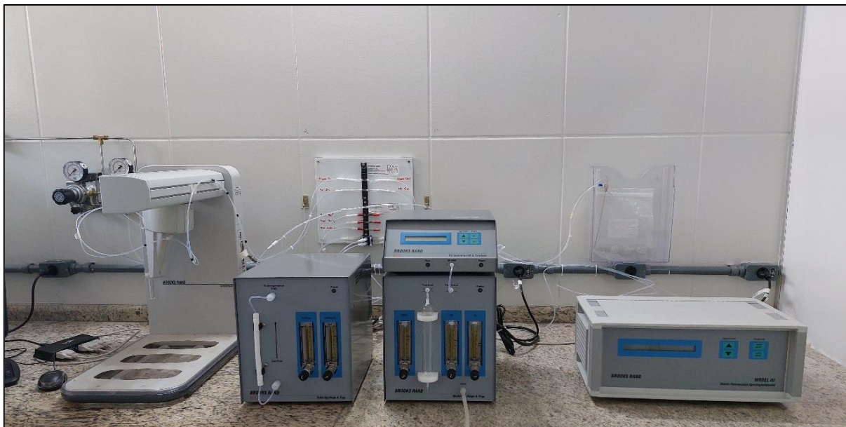
Figura 4. Cromatografia gasosa acoplada ao espectrômetro de fluorescência atômica (CG-AFS) (MERX-M - Brooks Rand®).
