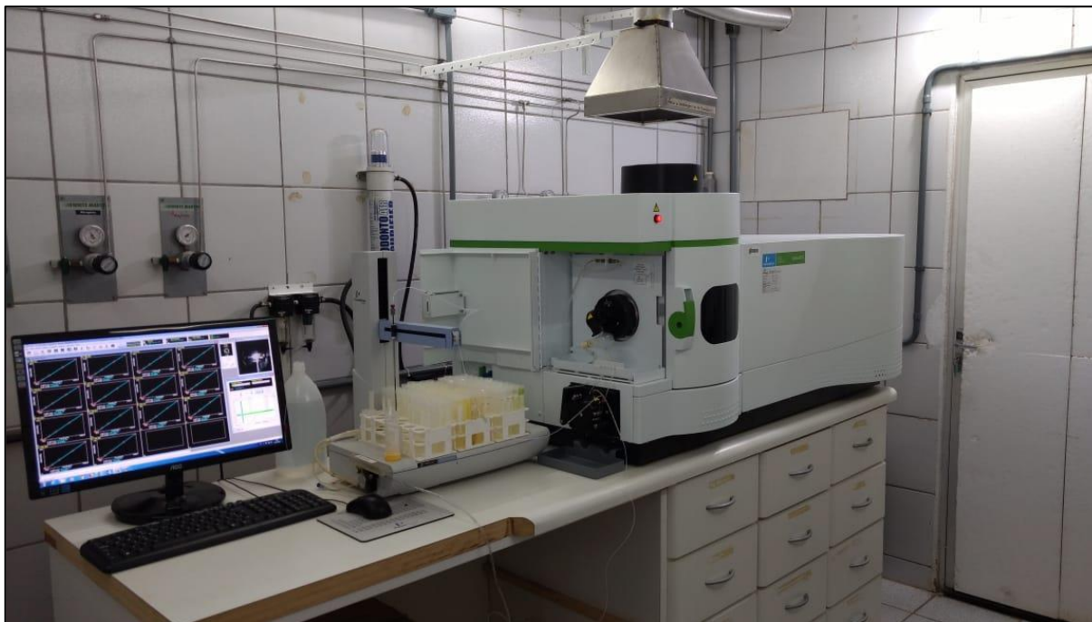
Figura 5. Espectrometria de emissão óptica com plasma acoplado indutivamente (ICP-OES) com geração de hidretos (ICP-OES-HG).
